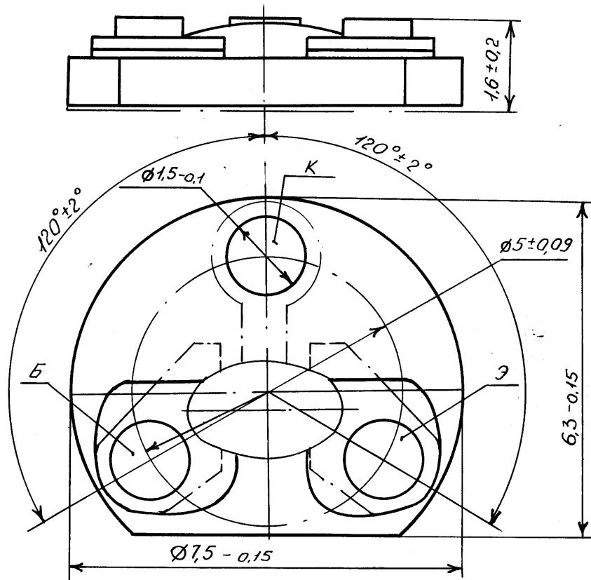
Рисунок 1. Чертеж кристалла КТ607А-4, КТ607Б-4
