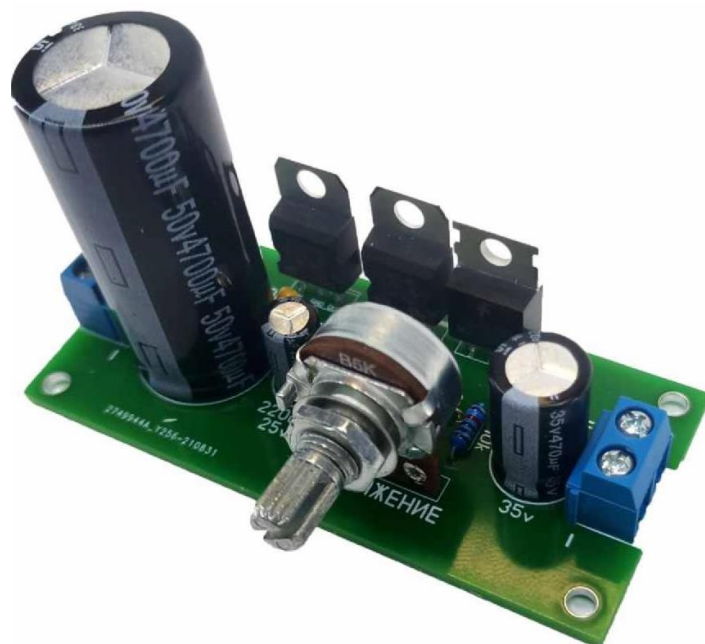
Регулируемый блок питания до 25В 8А. SMD резисторы и конденсатор.
