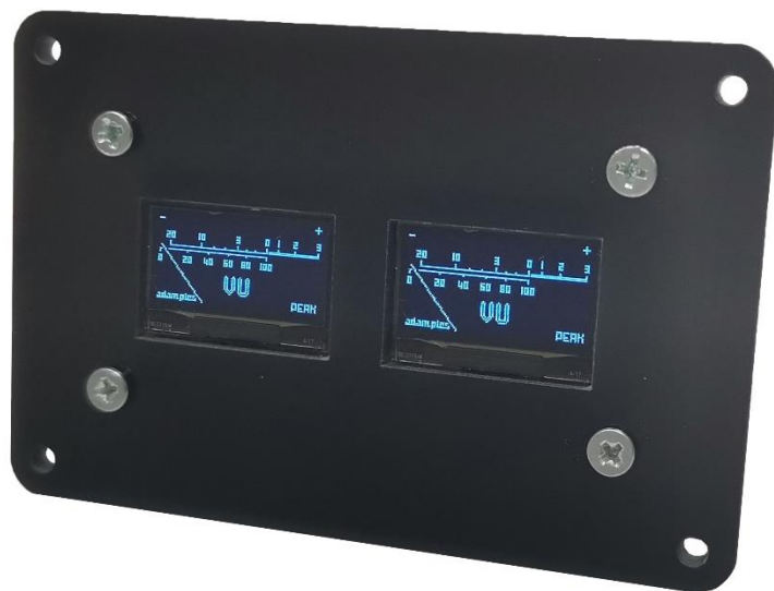
Сtereo измеритель уровня звука (VU meter) на AtMega328 и Oled экране
