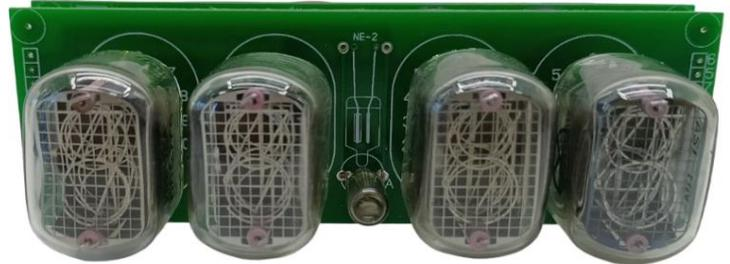
**Модуль индикации времени на газоразрядных лампах ИН-12.**
