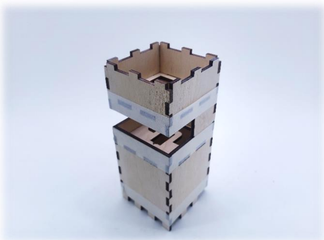
11. Для лучшей фиксации на время высыхания клея рекомендуется использовать малярную ленту
