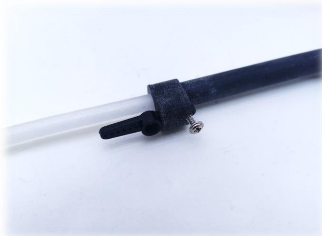
14. Установите крепление пушки к сервоприводу так, как показано на рисунке. Во избежание поломок не зажимайте саморез слишком сильно
