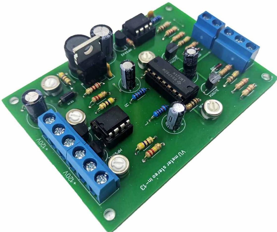
Подстроенным резистором, обозначенным на печатной плате «1К», установить на выходе, обозначенном на плате «120v», напряжение в 120 вольт. Подстроенным резистором, обозначенным на печатной плате «33К», регулируем уровень входного сигнала с источника. Подстроенным резистором, обозначенным на печатной плате «2.2К», регулируем уровень выходного сигнала на лампу.
