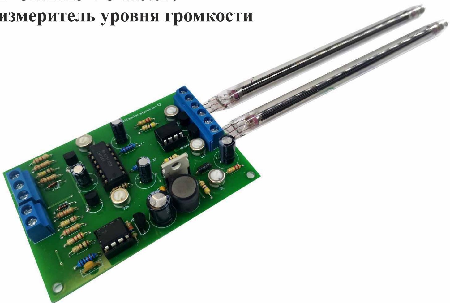
Подстроечным резистором, обозначенным на печатной плате «1К», установить на выходе, обозначенным на плате «120v», напряжение в 120 вольт. Подстроечным резистором, обозначенным на печатной плате «33К», регулируем уровень входного сигнала с источника. Подстроечным резистором, обозначенным на печатной плате «2.2К», регулируем уровень выходного сигнала на лампу.
