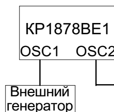
Схема формирования тактовой частоты от внешнего генератора
